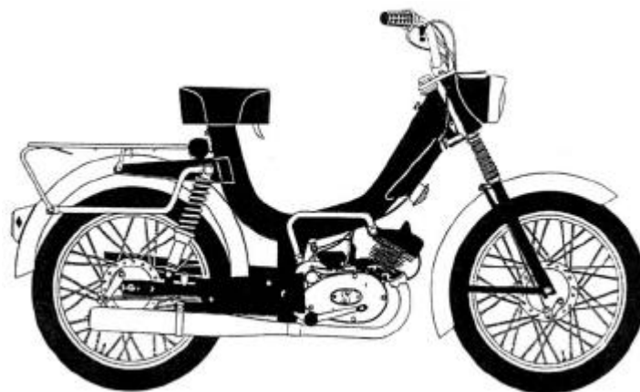
Moped 1248 är monterad med SACHS-motor, 50/2 KS, vårt nr 3311-0000-90, 2-växlad, med handväxel och kickstart.
